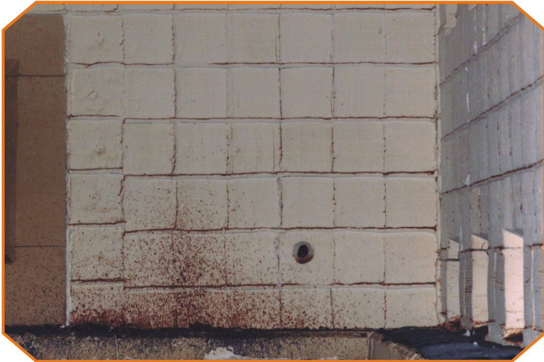
Zustellung frontseitig mit WEITHERM CFS 1430/220 - Modulen Hinterdämmung mit WEITHERM CTV 1260/260 - Platten
