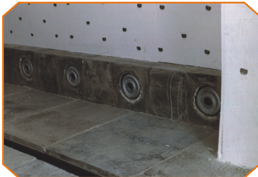
Festherd und Brennerbank mit WEITHERM CAST - Feuerbeton
